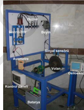
Şekil 3. Krank mili yanında endüktif anahtarlamalı elektronik ateşleme sistemi modeli
