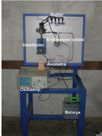
Şekil 2. Distribütör içinde endüktif anahtarlamalı elektronik ateşleme sistemi modeli
