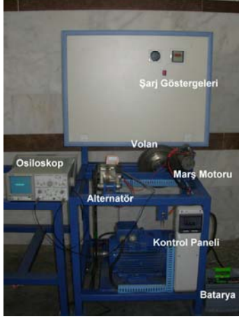
Şekil 4. Entegre şarj ve marş sistemi modeli
